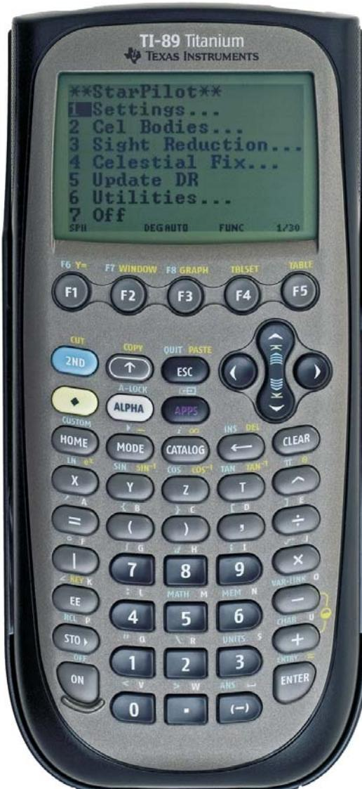
Der Starpilot Navigationsrechner umfasst alle erdenklichen Programme für die Astronavigation mit dem Sextanten. Zusätzlich sind eine Vielzahl von terrestrischen Navigationsprogrammen verfügbar. Standlinien lassen sich graphisch darstellen. Auch eine Routine zur Kompensierung des Magnetkompasses nach der Richtung des Sonnen-Schattens ist enthalten. Das grosse Anzeigendisplay ermöglicht eine komfortable Bedienerführung.
